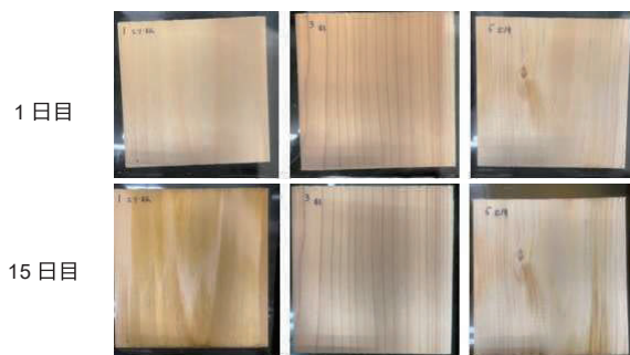
写真 3-2 放湿状態の木材表面状態 (含水率 18.5%→12%)
