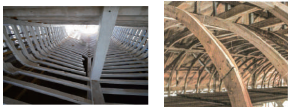
図 4-3 Dalcahue での造船所の製作中の木船の胴体構造（左）、Santa María de Nercón 教会の半円の骨組み（右）。（ヒメネス, 2023. Araya & Almonacid, 2022）
