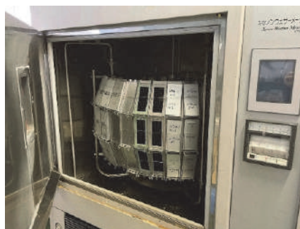
写真 3-2 ウェザーメーターを用いた試験の様子
