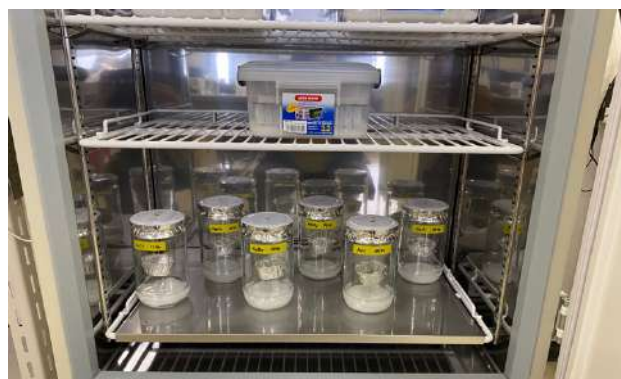
写真 3-4 平衡含水率測定実験の様子
