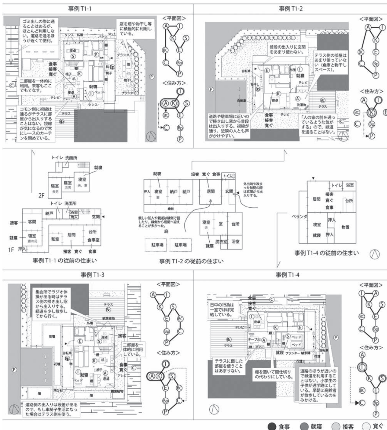
図 3-1 住宅とバッファー空間の利用（岩沼市 T 団地 B1 地区）
