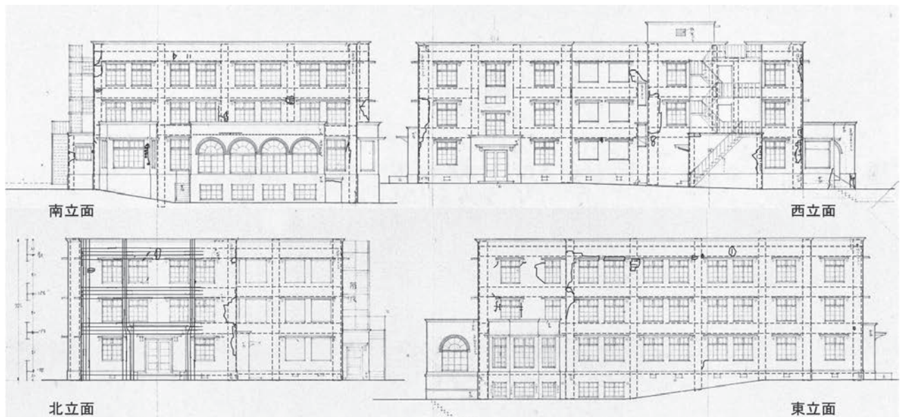
図4-1 鉄筋露出および仕上げ剥落箇所と壁梁・壁柱の配筋の対応（北立面の配筋は詳細図よりトレース，ほかの点線は推定）
