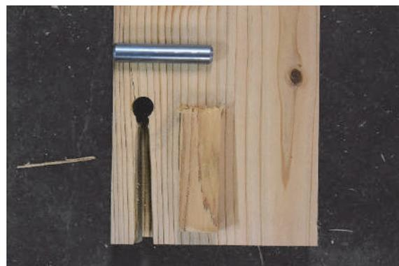
写真 3-3 破断面が 2 面のせん断破壊
