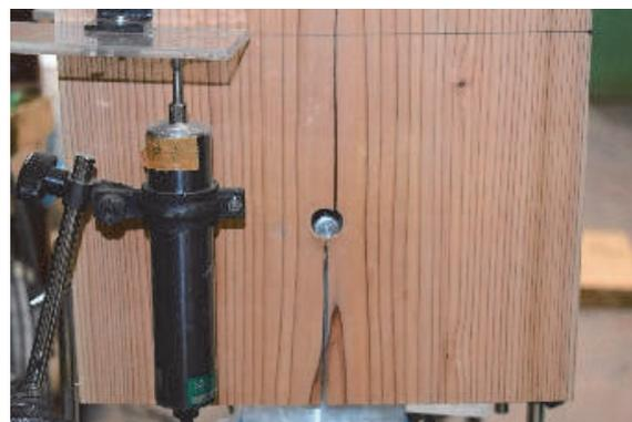
写真 3-2 破断面が 1 面の割裂破壊
