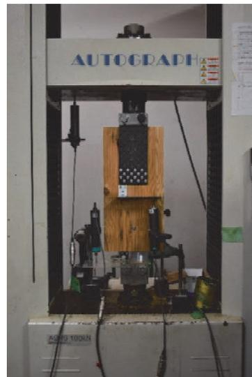
写真 3-1 割裂試験試験体セットアップ
