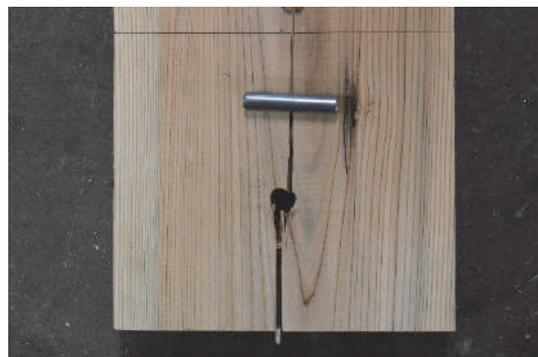
写真 付録-6 CE12V 破壊状況
