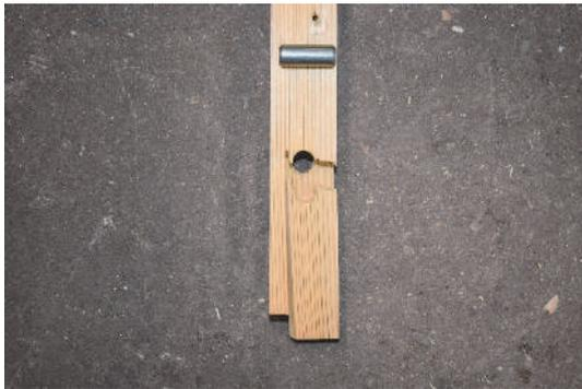
写真 付録-1 CE12Q 破壊状況
