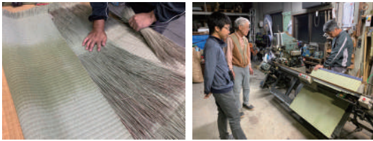
図 4-5 中継表の髭むしりと縁縫い
