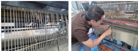
図 4-2 試運転で切れた麻糸とジシメの針間隔調整
