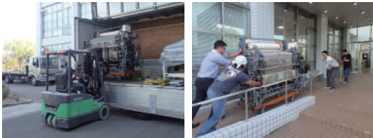
図 4-1 積み下ろしとキャスターを活用した搬入
