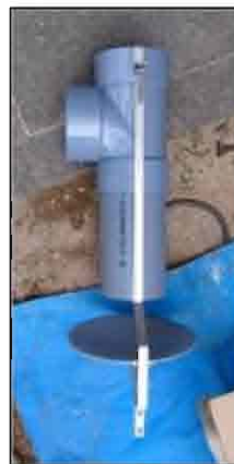
写真2-1 固液分離装置
