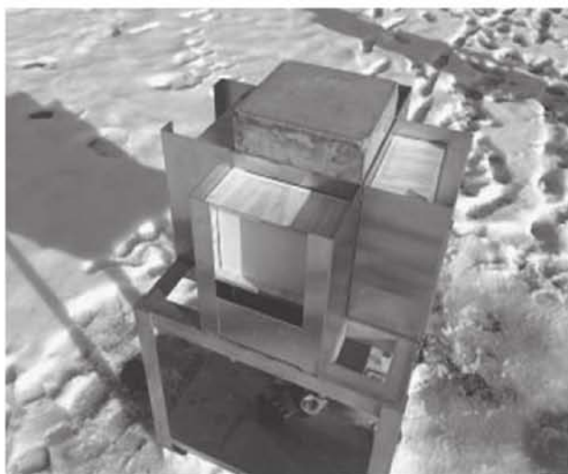
写真 2-4 放射線遮蔽検証器具による検証作業
