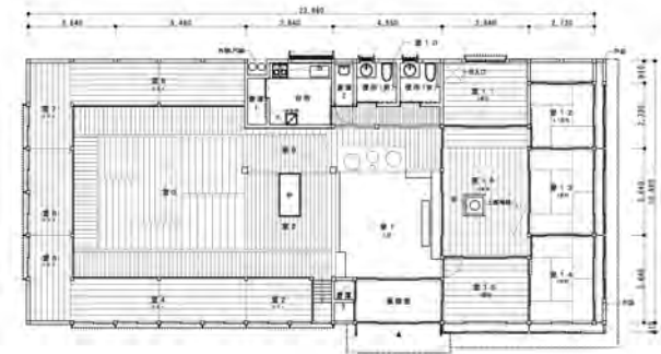
図 4-2 茨木家中出張番屋修理工事平面図（製図：山之内裕一）
