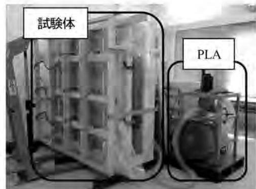
図 5-1: 実変動風荷重載荷試験装置
