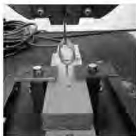
写真 7-2: 留め具引抜試験
