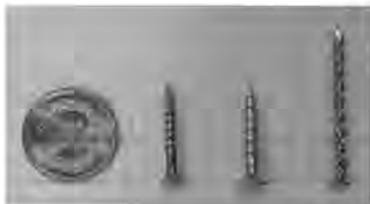
写真 7-1: 留め具引抜試験で用いた固定金具(左から留め具①, ②, くぎ)
