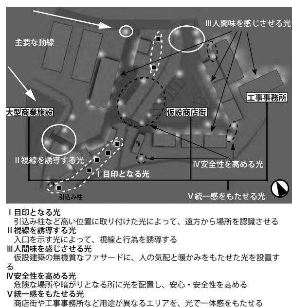
図3-11 仮設商店街の照明設置概念図
