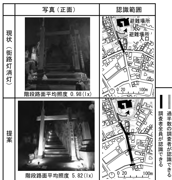
図4-6 仙寿院入口での照明実験と評価結果
