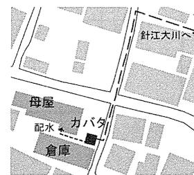
図 3-3 A 邸カバタ 配置と排水経路
