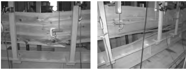
(1) 重ね梁試験体 (2) 平角試験体
