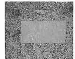
図4-3 ガムテープによる土壁表面への熱電対固定
