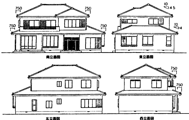
図2-1 木造軸組構法による2階建住宅
