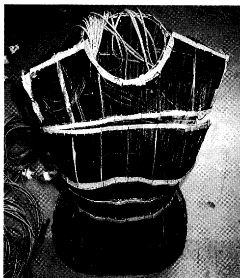
写真3-1 ステンレスヒーターの取り付け
