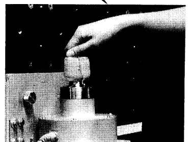
⑩:ガス元栓(回す)
